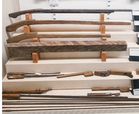
↑銃床の製作工程と道具類。未完成状態の銃床用材は、鉄砲研究会のメンバーの物置から見つかったもの。廣瀬さんは、この用材を一部もらい受けて銃床を復元し、壊れていた火縄銃の修理などをおこなった
