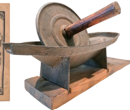
↑薬研。舟形のくぼみに生薬を入れ、軸のついた丸い円盤を前後させてすりつぶす道具
