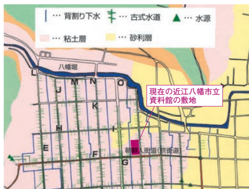
↑八幡町の古式水道と背割り（『近江八幡の歴史』第4巻に掲載の図「八幡町周辺の地質」を加工）
