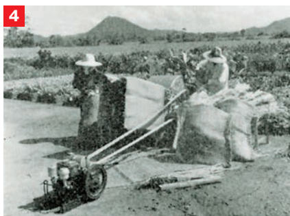
↓平ベルトでつないで糊摺機の動力として用いられているヤンマーのNK2型ディーゼル（昭和30年、『農機無限—ヤンマー農機20年のあゆみ』より）
